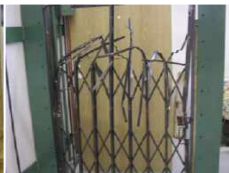
Nůžková mříž po testu – ČSN EN 1630:2022 na RC3
